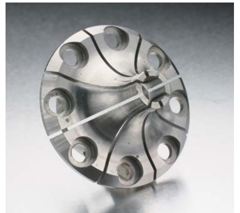
製造に必要な工具さえ自社で内製する。ラジアルエンドミル(左)とチャック(右)。
